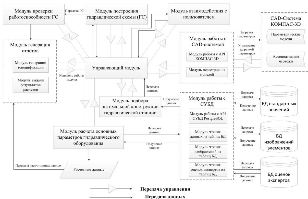
Рис. 2.9. Структурно-функциональная схема САПР СГС
